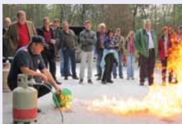
Stichflamme durch brennendes Propan gas in der Flüssigphase (Foto: R. Mark)
