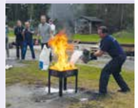
Ein Flüssigkeitsbrand wird mit PyroBubbles gelöscht.
