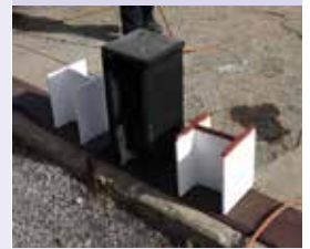
Die mittlere Stahlstütze wurde befeuert.
