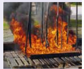
Brandverhalten von Kabeln.
