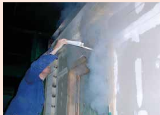
Rauch ist bei der Prüfung einer Feuerschutztür leider kein Kriterium. Hier wird lediglich die Verformung gemessen. (Foto: Pölzl)
