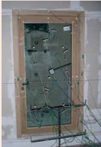
Messpunkte bei der Prüfung einer Feuerschutztüre.
