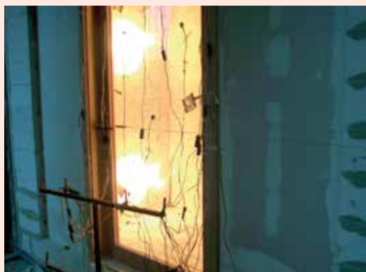
Im Prüfofen wird eine Holztür mit Glasfüllung geprüft. Sichtbar die Messsonden, die den exakten Temperaturverlauf dokumentieren. (Foto: Pölzl)
