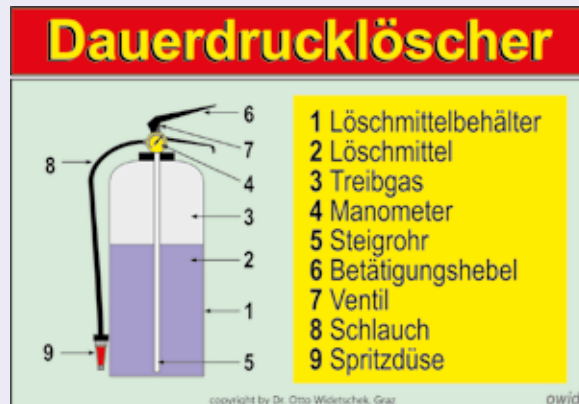
Aufbau eines Dauerdrucklöschers (schematische Darstellung).
