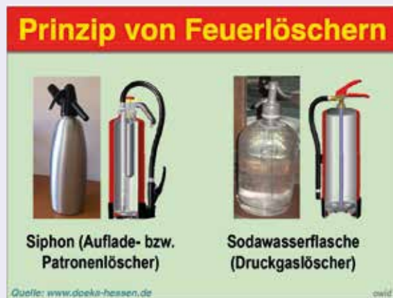
Prinzip Siphon und Sodawasserflasche.
