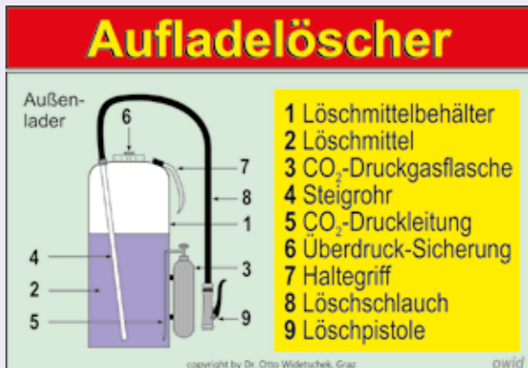
Aufbau eines Aufladelöschers mit außenliegender Treibmittelflasche (schematische Darstellung).
