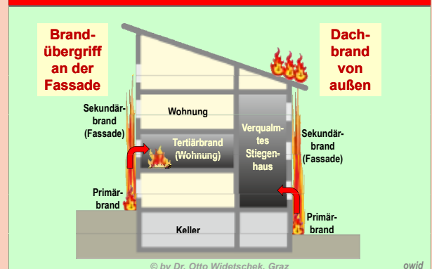
Neue Gefahren durch Fassadenbrände (schematisch).
