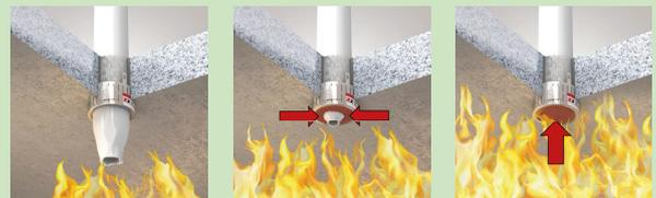
Kunststoffrohr wird plastisch und brennt ab
