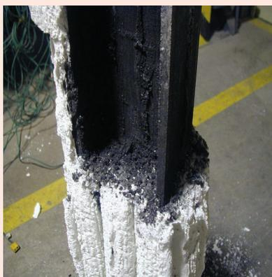
Anwendung als Anstrich für Stahlkonstruktionen und Beschichtung für Weichschotts (Quelle: Promat).
