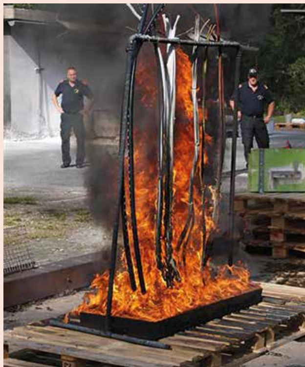
Brandversuche mit Elektrokabeln (Bild: Oswald).
