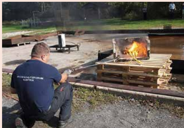
Praktische Demonstration an einem Kabelschott (Bild: Oswald).
