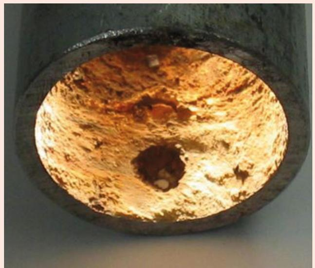
Lochkorrosion in einer Sprinklerleitung (Bild: VdS).
