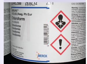
Neue Kennzeichnung nach GHS für Chloroform.
