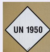
Kennzeichnung einer Verpackung (die UN-Nummer 1950 steht für Druckgaspackungen).
