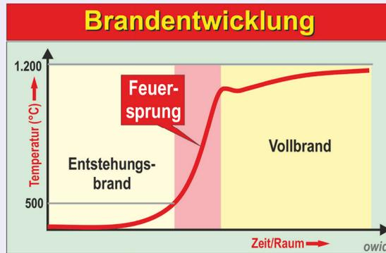
Schematische Darstellung eines Feuersprungs.
