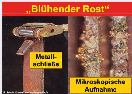
Korrosionen an einer Bimetallfeder (Quelle: R. Schuh).
