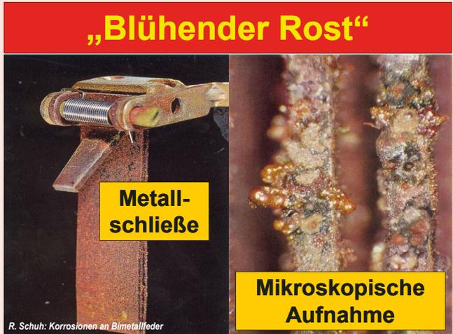
Rostschäden an einer metallischen Schließe (Bild: Schuh).
