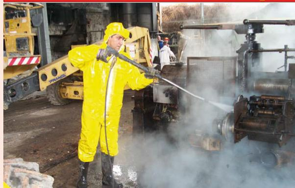
Heißwasser-Hochdruckverfahren bei einer Maschinensanierung (Bild: Belfor).
